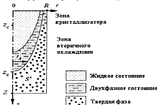
Рис.1. Схема непрерывной разливки стали
