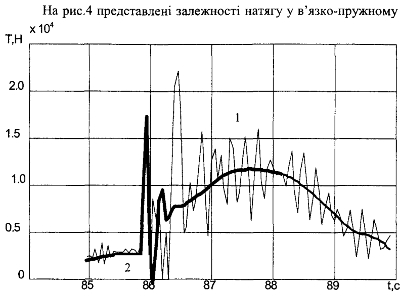
Рис.3. Натяг біля буйка в якорі 1 для пружного (1) і в'язкопружного (2) троса
