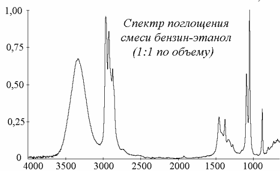
Рис. 3. Спектры поглощения прямогонного бензина и смеси бензин-этанол в ИК-области
