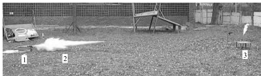
Рис. 6. Средняя фаза распространения импульсной струи жидкости.
