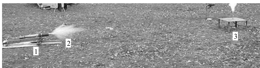
Рис. 5. Начальная фаза распространения импульсной струи жидкости.
